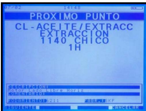
Al aceptar con el comando SIGUIENTE el colector comenzará a medir la primera medición del primer punto.
