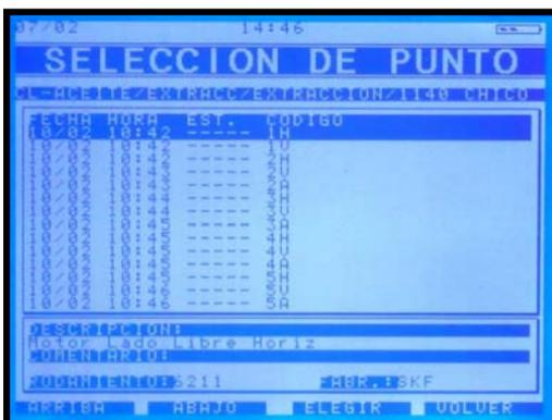
Además de mostrar una lista de los equipos de la ruta, en la parte inferior de la pantalla muestra el detalle de cada equipo seleccionado.
