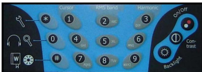
Además mientras se mide vibración se puede activar el control de volumen del auricular con la tecla cero (0) y con la tecla numeral (#) se puede llamar al diccionario sobre los campos de ingreso de caracteres.
