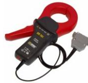
El estado de las barras del rotor en un motor a inducción pueden medirse, haciendo un análisis de frecuencia con alta resolución de la corriente de entrada del motor.
