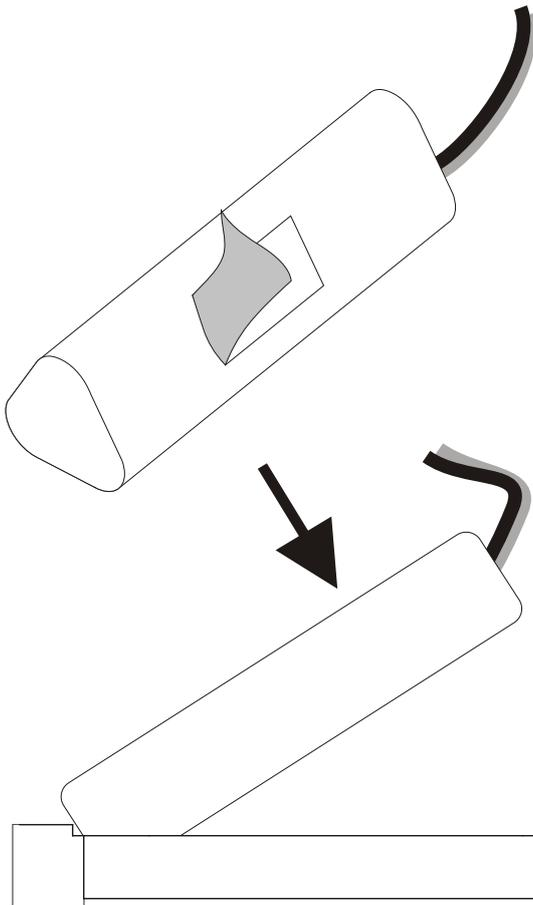
Destape el adhesivo en la batería nueva.
