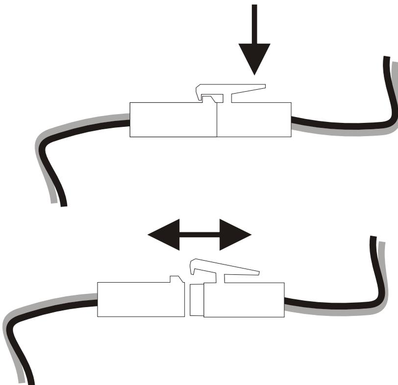
Presione la traba de seguridad y separe el conector de la batería
