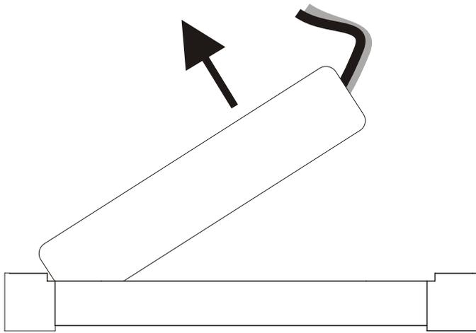
Despegue la batería agotada de la base de metal y limpie la superficie con un trapo embebido en alcohol
