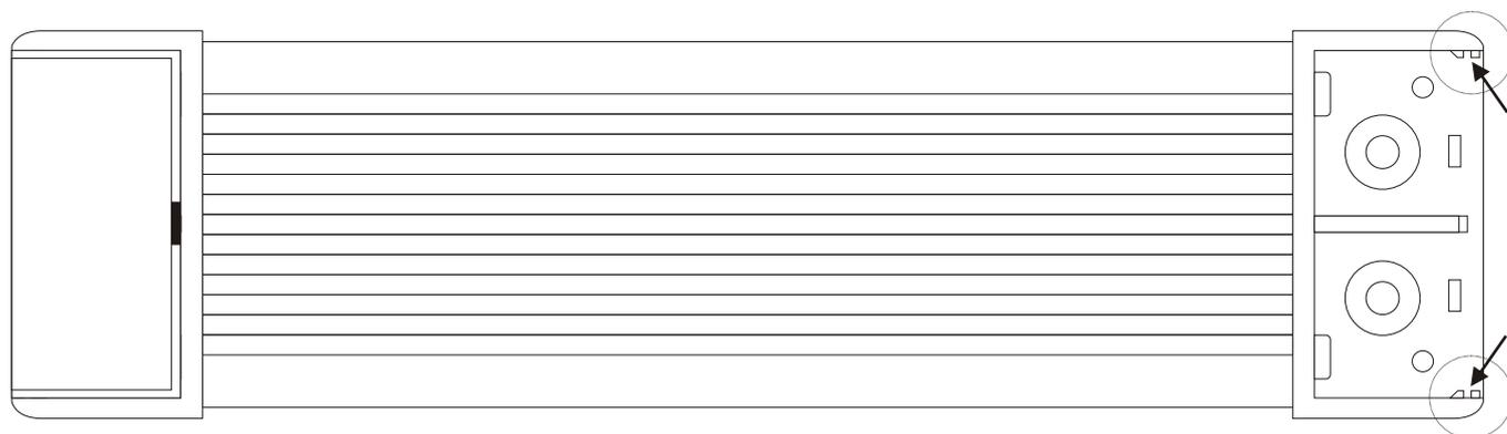
Coloque las protecciones plásticas haciendolas deslizar por las muescas indicadas, hasta que traben.
