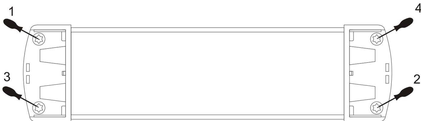
Desatornille la tapa inferior del gabinete, respetando el orden indicado en la figura
