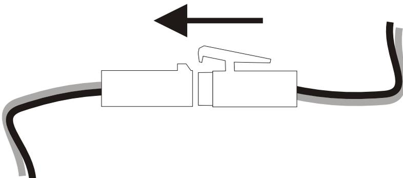
Enchufe el conector de la batería al del equipo, NO LO FUERCE, el conector solo entra de una manera.
