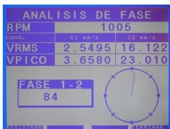
Este es un firmware totalmente nuevo, con un nuevo sistema de detección y procesamiento de señal, puede mostrar la diferencia de fase, en forma muy estable en pequeñas amplitudes de vibración o en grandes diferencias vibratorias entre distintos puntos.
